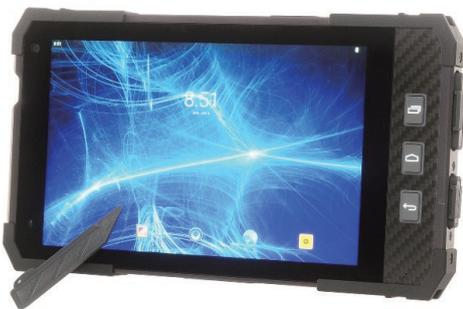
機構設計方面，DP10A 採用高強度工程塑膠與經 CNC 精密加工之鋁合金機殼組成，確保結構穩定性與高精度組裝，顯著提升抗衝擊、抗變形與散熱效能。此平板電腦通過 MIL-STD-810H 認證，經測試可耐受極端溫濕度、機械衝擊、震動等嚴苛環境條件，適用於高風險工業或戶外作業場景。此平板電腦同時也具備 IP65 等級防護能力，可有效防止粉塵及水柱進入，提升在高粉塵或潮濕環境下的操作可靠性。
